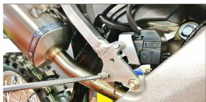
**ITA** Fissare curva silenziatori al telaio con le viti M8x20 e le rondelle 8x16, in dotazione
