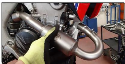
**ITA** Inserire prima i collettori destro e sinistro nella boccole e fissarli con le molle corte con gommino, utilizzando il tira-molla in dotazione
