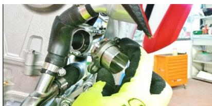
**ITA** Montare la ghiera sulla boccola e alloggiarle nell'attacco testa, fissandole con i dadi originali
